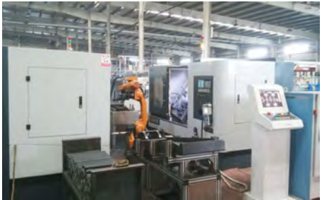
GSK980TDC通过GPC组网配套机器人在上海某公司电机转轴生产线上的现场照片
